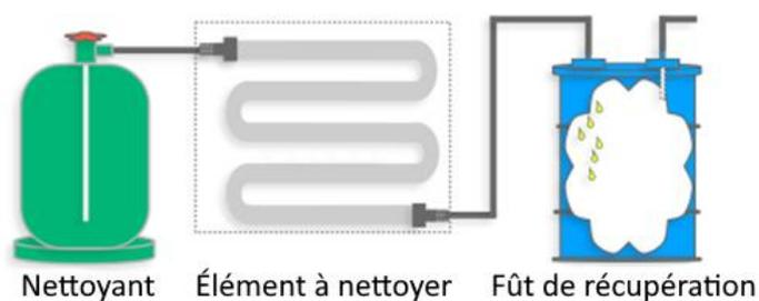
Nous recommandons de démonter les accessoires de l'installation (électrovannes, ...) éventuellement présents afin d'éviter toute détérioration liée au produit de nettoyage.
