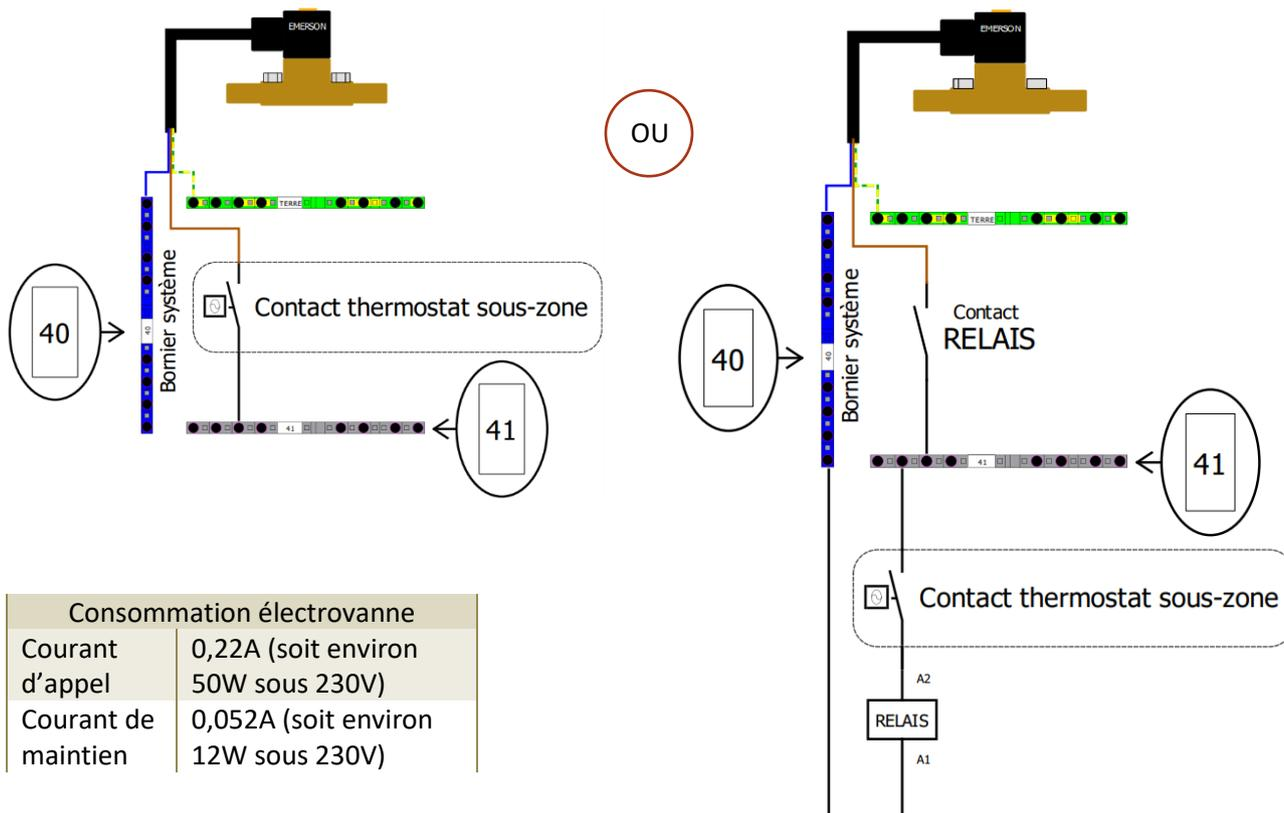
Dans le cas d'une zone à la baisse, raccorder l'électrovanne en série avec le contact du thermostat de zone à la baisse (schéma de gauche). Si votre thermostat ne supporte pas le courant consommé par l'électrovanne (voir tableau ci-dessus), câbler l'électrovanne en série avec un relais (schéma de droite, ici avec bobine alimentée en 230V depuis la PAC).
