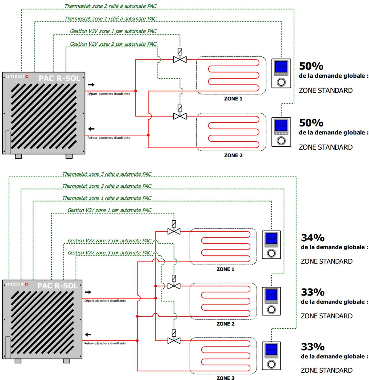
Dans le cas d'un remplacement de 2 ou 3 modules sol/sol sur 2 ou 3 planchers de taille équilibrée, il faut mettre en place des zones standard. Pour cela, mettre en place une électrovanne par plancher et relier les départs et les retours à la R-SOL.
