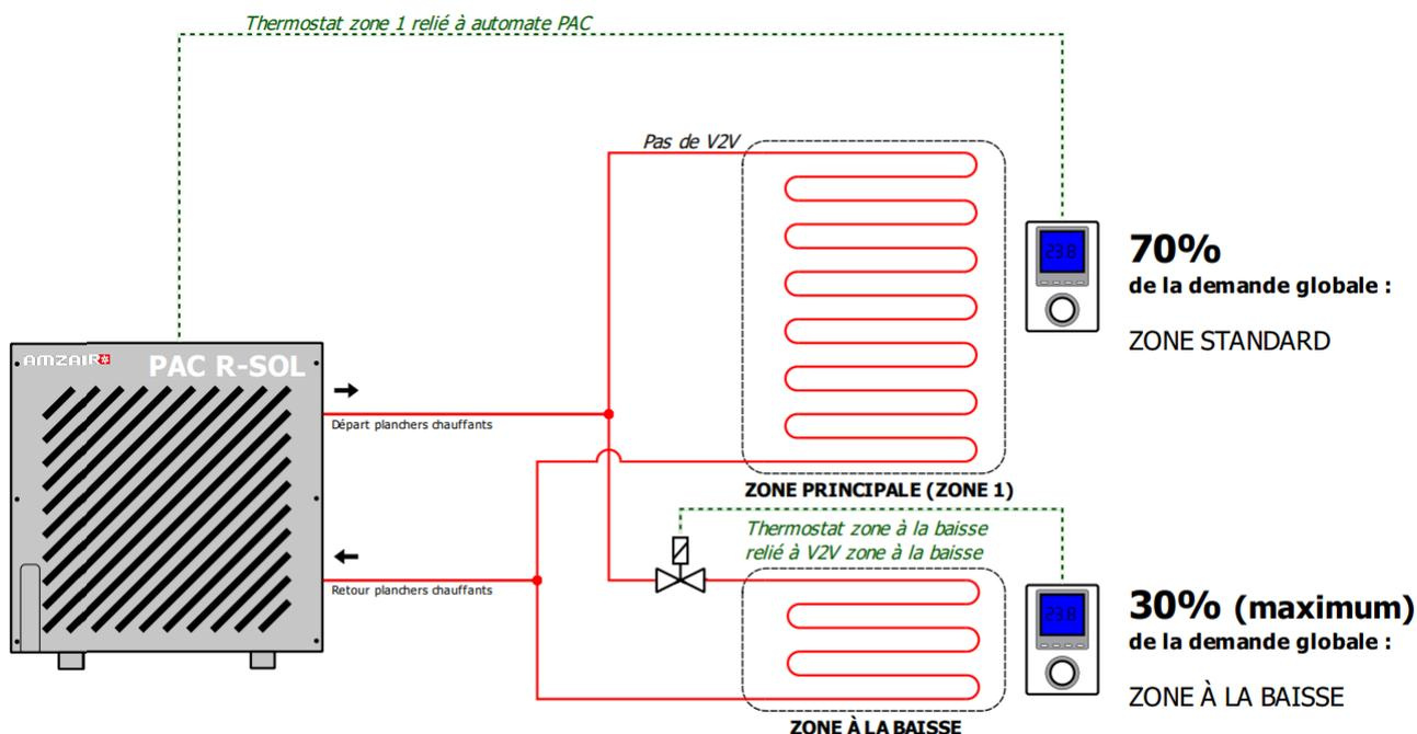
Dans le cas d'un remplacement d'un seul module sol/sol sur 2 planchers de taille différente, dont le **plus petit plancher n'excède pas 30% de la demande en puissance totale**, il est possible de mettre en place une zone à la baisse. Pour cela, mettre en place une électrovanne pour le petit plancher et relier les départs et les retours à la PAC R-SOL.
