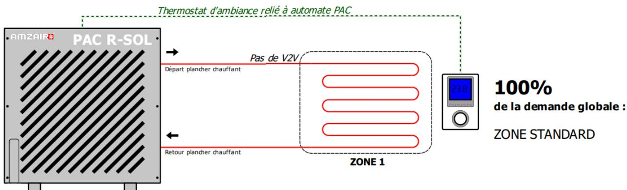
Dans le cas d'un remplacement d'un seul module sol/sol sur un seul plancher, relier le départ (gaz chaud) et le retour (liquide chaud sous-refroidi) directement à la R-SOL. Dans ce cas il n'y a pas gestion par zones (l'unique zone sera reconnue comme zone 1 pour l'automate de la PAC).
