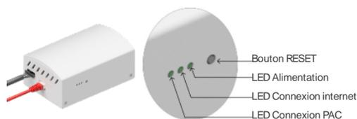
Une fois la PAC sous-tension, la LED Alimentation et LED Connexion PAC doivent être allumées ainsi que la LED connexion réseau si le boîtier est relié à internet. Le système peut mettre jusqu'à 2 min à s'allumer.
