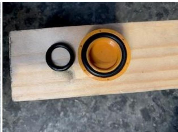
3) Déposer la bobine, insérer le petit joint torique sur la cheminée puis remettre la bobine ergots face à l'opérateur
