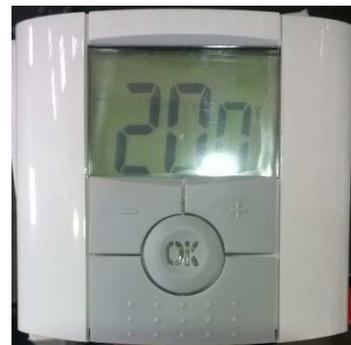
Pour changer la configuration de l'installation, modifier un paramètre, programmer un fonctionnement horaire automatique ou visualiser l'état de fonctionnement de la PAC (avec consultation possible des messages de défauts ou alarmes), il faut utiliser l'afficheur déporté qui se branche directement sur le port USB de la carte automate.
