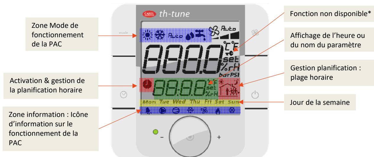
\* Lors de l'appui sur un bouton ou une combinaison de boutons de l'e-Th (Th-Tune) et qu'aucune fonction n'est associée, un symbole de clé s'affiche pendant 1 seconde.
