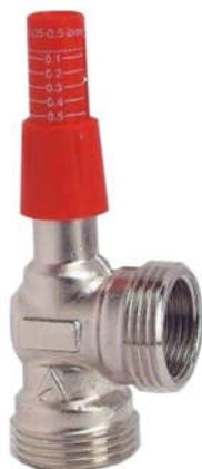
La soupape différentielle limite les effets des variations de pression et de débit, lors du basculement de la V3V ECS, V2V ( durée de fermeture 6 minutes ) ou en phase de dégivrage par exemple.
