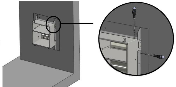
1. Fixer les 4 équerres d'encadrement à l'aide de vis (non fournies) dans la manchette en s'assurant bien que celles-ci soient bien plaquées contre le mur (3 vis pour l'équerre côté et 2 vis pour l'équerre horizontale, voir zoom).
