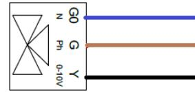
Alimentation de la vanne 3 voies (V3V) de mélange : **24 Volts alternatifs**
