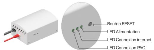
Une fois la PAC sous-tension, la LED Alimentation et LED Connexion PAC doivent être allumées ainsi que la LED connexion réseau si le boîtier est relié à internet. Le système peut mettre jusqu'à 2 min à s'allumer.
